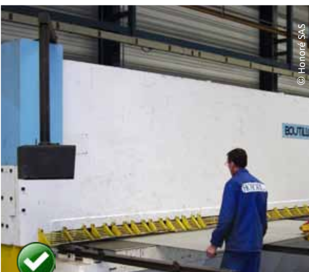
Fig. La existencia de un resguardo fijo impedirá la entrada de las manos o dedos más allá del límite de la línea de peligro durante el trabajo con la cizalla-guillotina.
