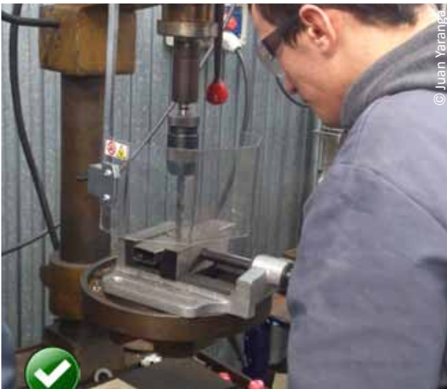
Fig. Taladro de columna con resguardo regulable de protección de la zona de operación.
