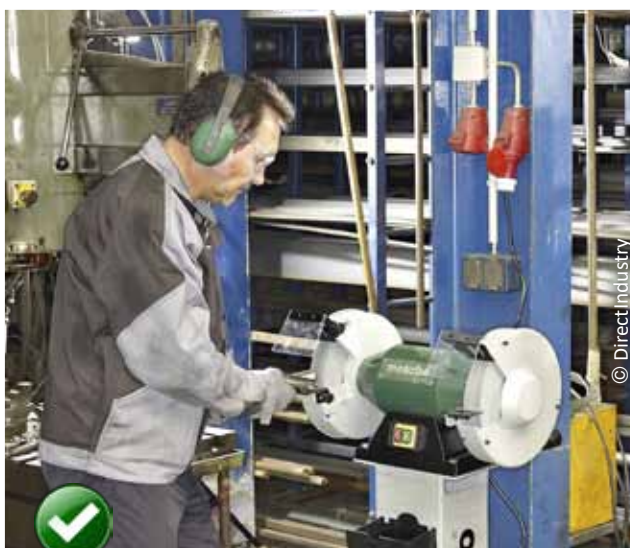
Fig. Resguardos de la esmeriladora para la protección frente a proyecciones en la zona de esmerilado, y empleo de equipos de protección individual.
