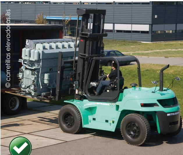
Fig. Manipulación de una carga muy pesada mediante una carretilla de capacidad adecuada, y con una correcta disposición sobre la horquilla.
