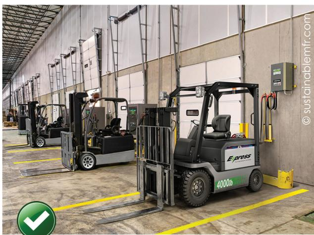
Fig. El estacionamiento de las carretillas debería llevarse a cabo en lugares designados para ello, siempre que sea posible, y aplicando una serie de pautas básicas que aseguren su total inmovilización, además de no impedir el paso ni la circulación.
