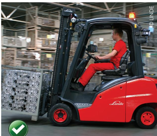
Fig. Circulación con la horquilla levantada a la altura mínima sobre el suelo, facilitando la visibilidad del conductor de la carretilla.
