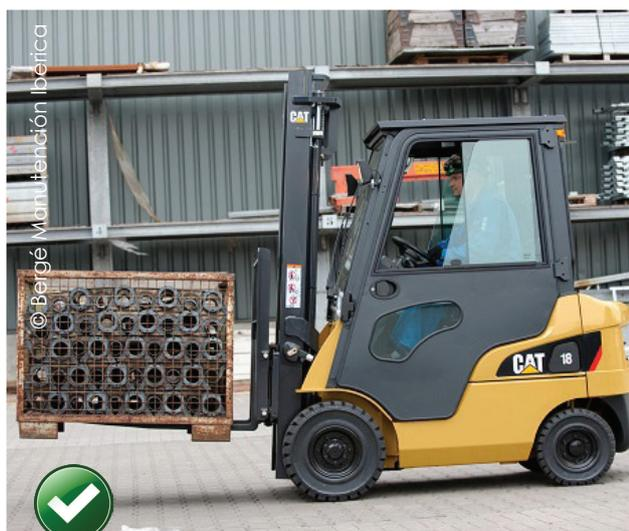
Fig. Transporte con carretilla elevadora de una carga no paletizada, empleando un contenedor para evitar su caída durante la manipulación.
